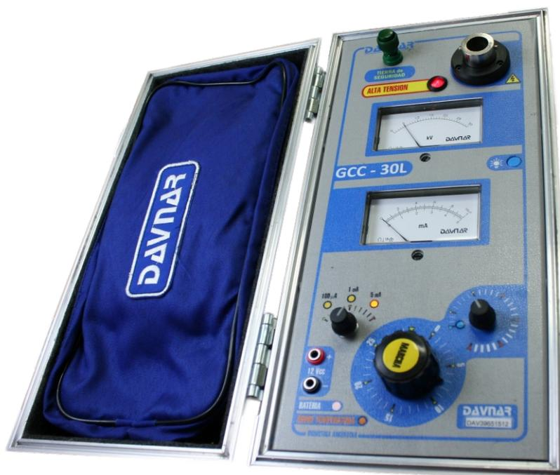
Generador de corriente continua para ensayos de rigidez dieléctrica, con protección por sobrecarga y enclavamientos de seguridad.
